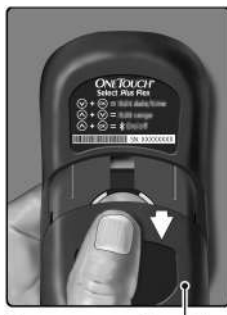
Крышка отсека батареек
