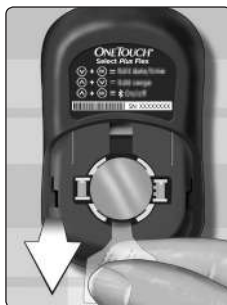
Крышка отсека батареек
